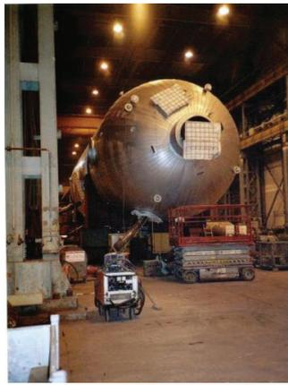
El secado correcto y controlado de los refractarios es de suma importancia para la industria procesadora de hidrocarburos ya que, no solamente mejora la durabilidad del material refractario, sino que también minimiza el tiempo de parada durante las reparaciones y previene la falla prematura del material refractario por secado incorrecto del revestimiento nuevo.
